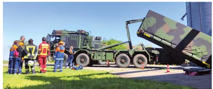
Absetzen einer Wechsellpritsche vom ungeschützten Wechsel-ladefahrzeug Multi 15 Tonnen (Foto: Rathmann)
