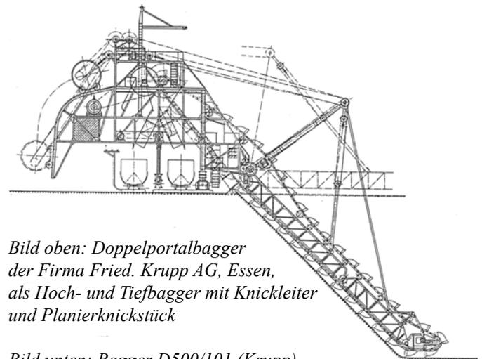
Bild oben: Doppelportalbagger der Firma Fried. Krupp AG, Essen, als Hoch- und Tiefbagger mit Knickleiter und Planierknickstück
